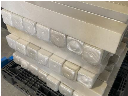
インゴット1本あたり10kg 体積1/100で大幅な輸送効率化
