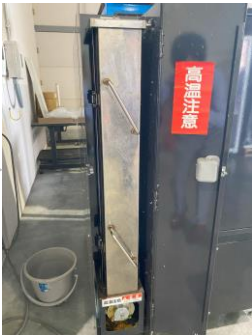
熱で熔融後、側部の箱に流し込み、冷却して固まると完成
