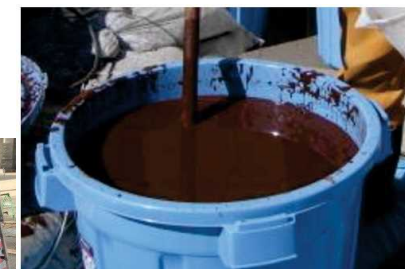
注入薬剂(吸着剂・酸化鉄微粒子)
