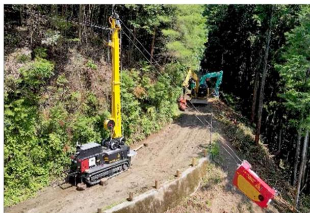
遠隔操作機能を搭載した先進林業機械
