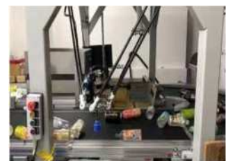
A I 選別設備
