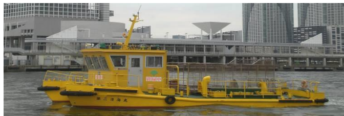
船名 第二清海丸 トン数14トン 平成12年3月竣工 長さ13m 幅6.6m 深さ1.7m 馬力230ps×2基
