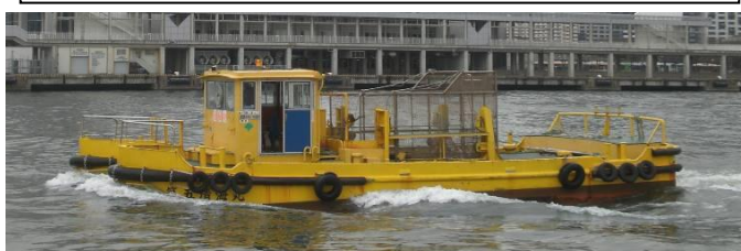
船名 第五清海丸 トン数15.64トン 昭和54年12月竣工 長さ11.2m 幅5.5m 深さ1.7m 馬力230ps×2基
