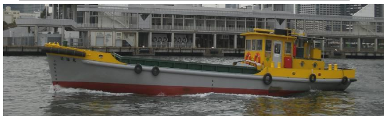
船名 第六清海丸 トン数16.26トン 昭和50年3月竣工 長さ10.9m 幅6.4m 深さ1.6m 馬力105ps×2基
