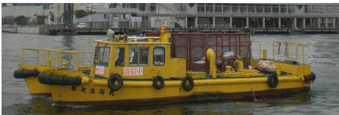
船名 第七清海丸 トン数10.9トン 昭和55年3月竣工 長さ10.9m 幅6.4m 深さ1.6m 馬力150ps×2基
