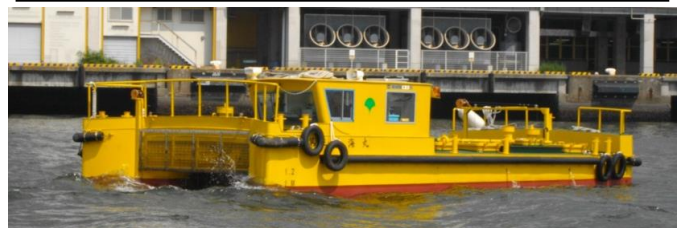
船名 第三清海丸 トン数6.6トン 平成28年3月竣工 長さ10.7m 幅5.1m 深さ1.7m 馬力182ps×2基
