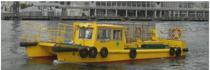
船名 第六清海丸 トン数16.26トン 昭和50年3月竣工 長さ10.9m 幅6.4m 深さ1.6m 馬力105ps×2基
